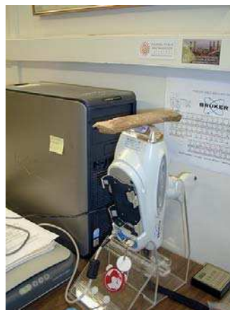
Fig. 2. Macchina XRF portatile durante l'analisi di un osso
