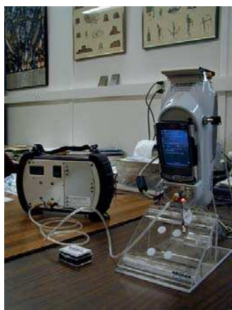
Fig. 1. Macchina XRF portatile con accessorio per creazione del vuoto
