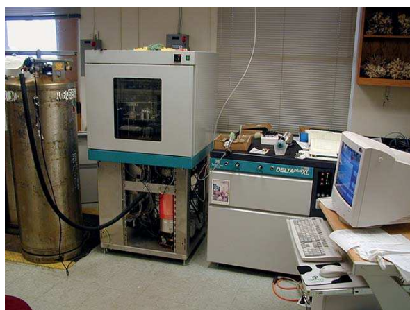
Fig. 3. Laboratorio con spettrometro di massa per analisi isotopiche (in corso)
